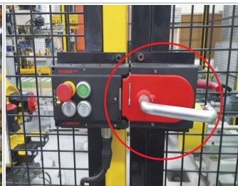
연동장치(Interlock) 설치
