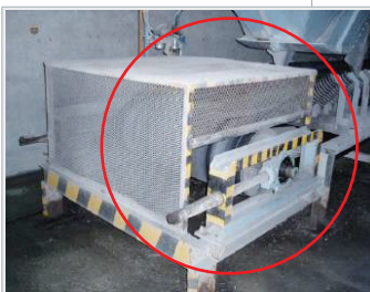
테일풀리* 방호울 설치 (컨베이어 끝단을 지지하는 풀리)
