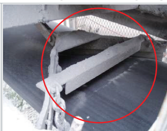
스크레이퍼* 설치 (벨트에 정착된 퇴적물 제거 장치)
